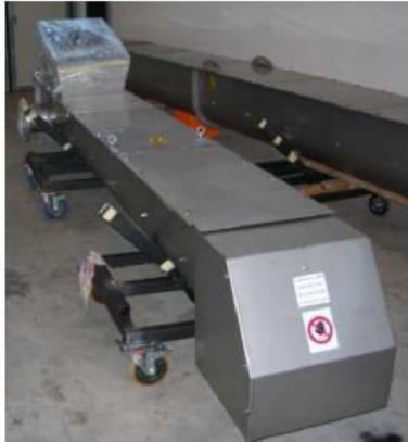
CCS / V transportor cu surub vertical fără ax
